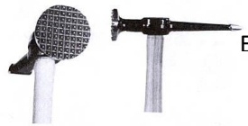
Figure1- 4 (A) Double round hammer (B)&(E) Shrinking hammer (C) Off-set bumping hammer (D) Dinging hammer
